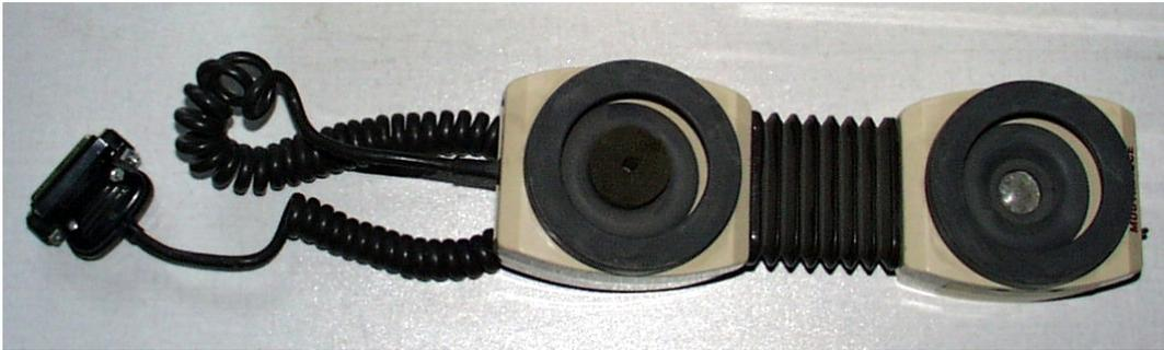
In den frühen 80er Jahren kamen auch Akustikkoppler wie der Gezeigte zum Einsatz, bei denen Sende- und Empfangsdatenrate unterschiedlich waren (75/1200 bit/s) und die damit in gewisser Weise die heutige "Asymmetrie" von DSL vorwegnahmen.
