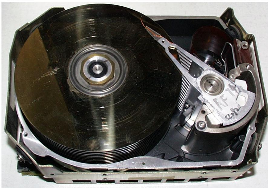
Festplatten im 5¼-Zoll-Format waren im Bereich der Workstations lange Zeit die größten verfügbaren Plattenspeicher. Die technische Entwicklung dieser Platten endete etwa im Jahre 1995 mit einer 35 Gbyte-Version. Die nächst kleinere Festplatte (3½-Zoll-Format) erreichte bereits im Jahre 1990 eine Kapazität von einem Gigabyte. Sie wird in diesen Abmessungen noch heute gebaut und dürfte etwa 2008 eine Kapazität von einem Terabyte erreichen.
