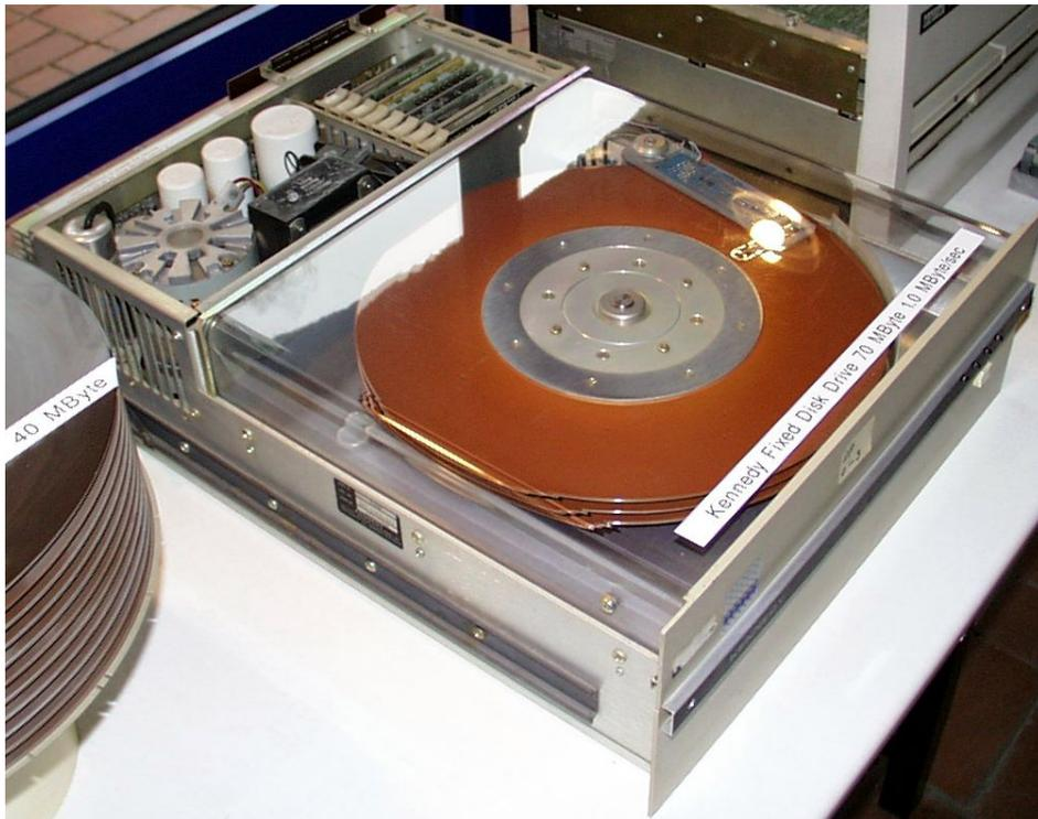
Dieses Magnetplattenlaufwerk war eines der ersten in der so genannten Winchester-technologie. Diese zeichnet sich dadurch aus, dass:
