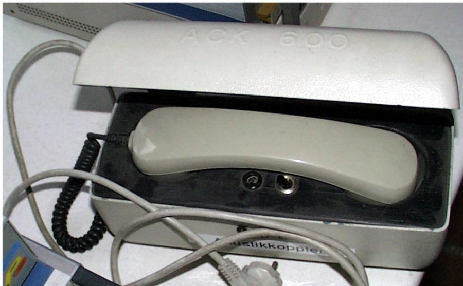
Da auch Akustikkoppler sehr teuer waren, hat das Fritz-Haber-Institut die Entwicklung des preiswerten Akustikkopplers ACK600 durch Vorabbestellung von etwa 10 Stück bei einer kleinen Berliner Firma unterstützt. Dieses Gerät war bereits für die nächst höhere Datenrate von 600 bit/s vorbereitet, die jedoch nie zum Einsatz kam.
