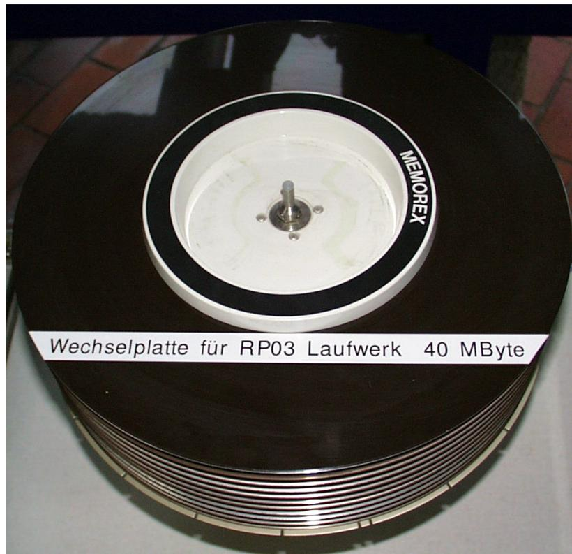
Das Wechselpplattenlaufwerk RP03 war im Fritz-Haber-Institut in der Zeit zwischen 1974 (4 Laufwerke) und 1984 (12 Laufwerke) im Einsatz. Anfangs waren auf diesem Plattentyp noch das Betriebssystem für das DECSYSTEM10 und die Daten aller Benutzer gespeichert. Zuletzt wurden Laufwerke diese Typs ausschließlich als "private disks" zum Speichern größerer Datenmengen einzelner Benutzer eingesetzt.
