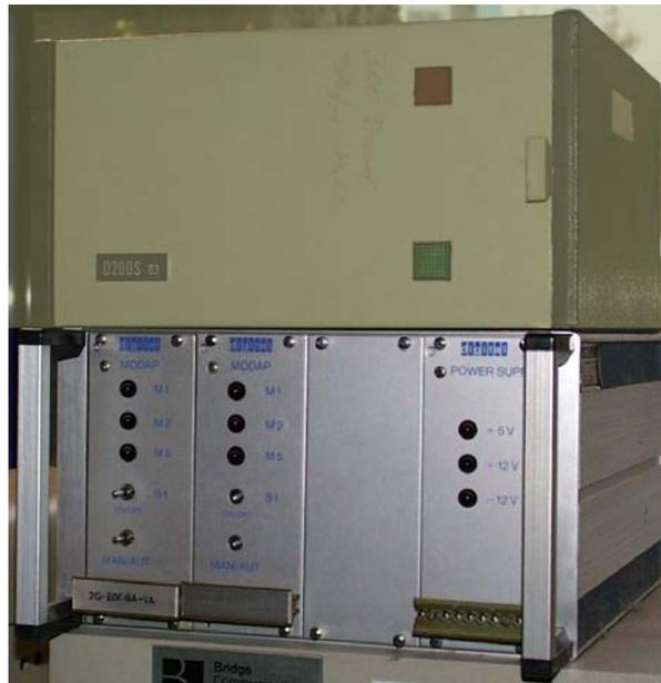
Zum Betrieb des Modems war die Installation des (praktisch funktionslosen) Modemadapters (unter Teil des Bildes) von der Post zwingend vorgeschrieben.
