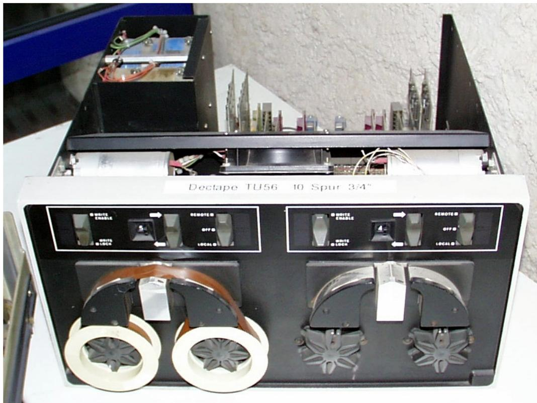
Das DECTape, noch in den 60er Jahren entwickelt, kann als Vorläufer der Floppy-Disks angesehen werden, obwohl als Speichermedium ein Magnetband verwendet wird. DECTape war ein sehr robustes Medium, da alle Informationen doppelt auf das Band geschrieben wurden. Das ¾-Zoll breite Band wurde in 10 Spuren beschrieben, wobei
